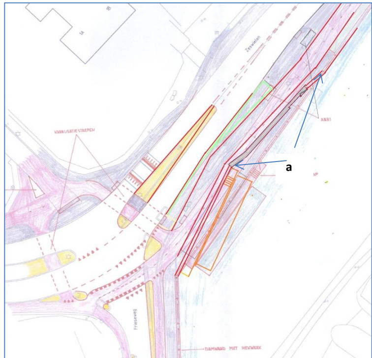
Alternatief verloop van de beschoeiing met behoud van een zichtbare kademuur (a) is mogelijk indien de bushalte iets noordelijk wordt verschoven.
