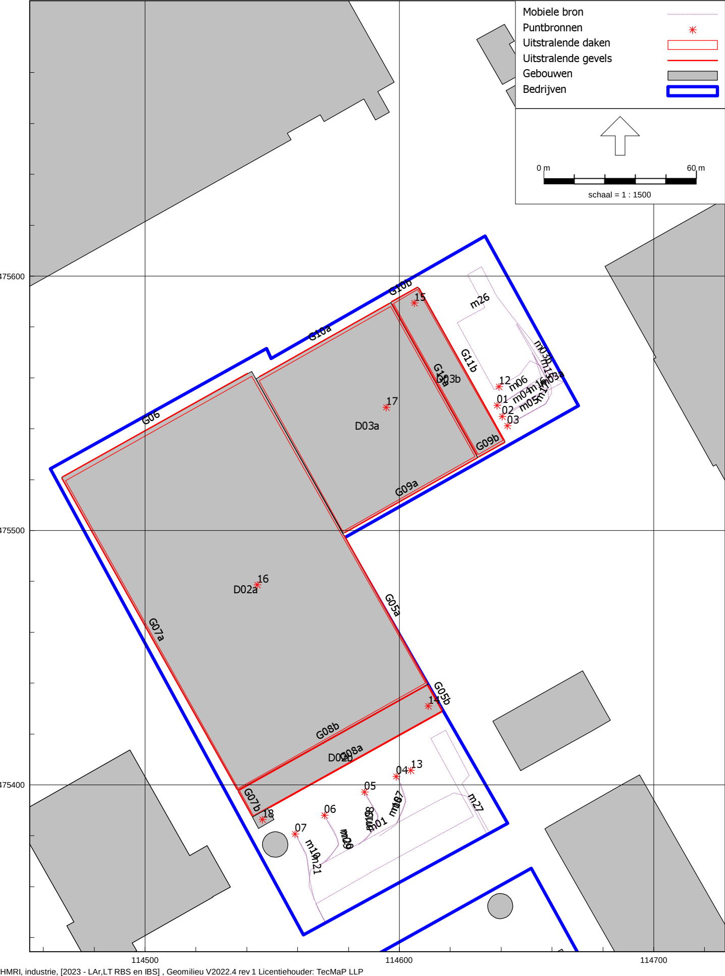
figuur 5: Overzicht rekenmodel met positie geluidbronnen
