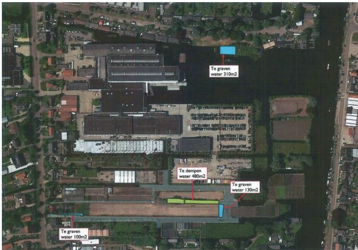
Figuur 8 Demping van boezemwater en compensatie
