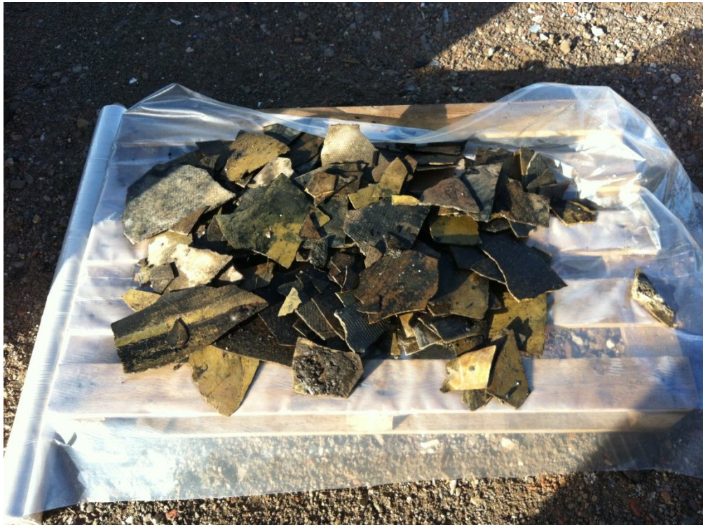
Foto 13, detail verzameld asbesthoudend materiaal.
