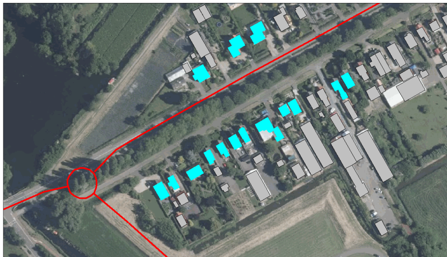
Figuur 5.5: Overzicht van de woningen waarvoor een geluidstoename berekend is van 2 dB of meer ten gevolge van de reconstructie van de Aalsmeerderweg
