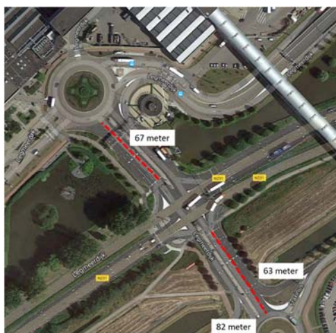
Figuur 3.1: Beschikbare wachtrijlengte noord- en zuidtak kruispunt
