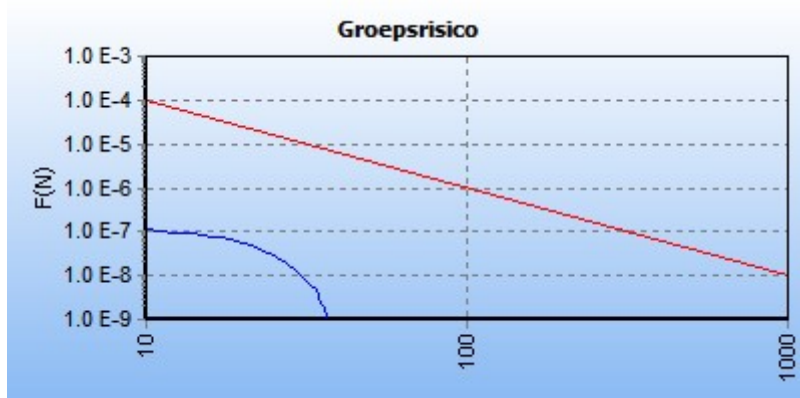
5.1 Figuur 5.1 FN curve voor 5227_leiding-W-529-01-deel-1 van N.V. Nederlandse Gasunie voor de kilometer tussen stationing 4260.00 en stationing 5260.00
