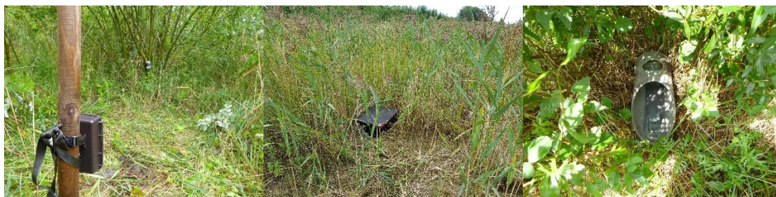
Figuur 3. Geplaatste onderzoeksmethoden. Links de Jiggler; midden een marterbox; rechts een Struikrover
