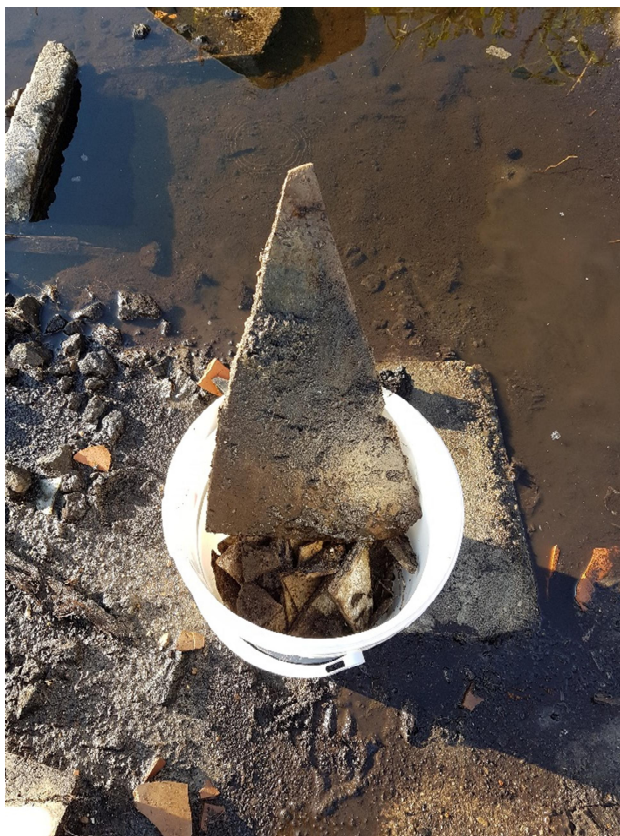
Foto 4: asbestverdacht materiaal afkomstig van maaiveld RE III
