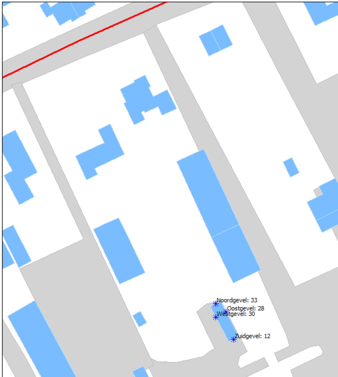
Afbeelding 3: Rekenresultaten in dB per bouwlaag voor het geluid van de Uiterweg na aftrek van 5 dB conform artikel 110 Wgh
