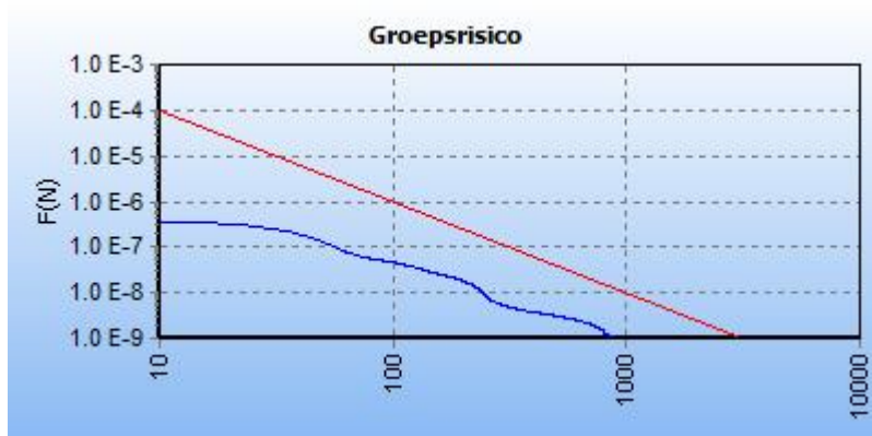
5.1 Figuur 5.1 FN curve voor 9202_leiding-A-510-deel-1 van N.V. Nederlandse Gasunie voor de kilometer tussen stationing 2310.00 en stationing 3310.00
