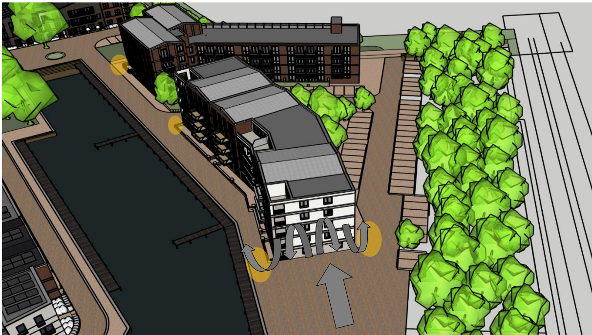
Figuur 8: Bepalende luchtstromingen waarbij lucht tegen het gebouw aan stroomt en langs de hoeken over het maaiveld versnelt (grijze pijlen) en de hoeken waar dit effect op zal treden (oranje vlakken) voor zuidwesten wind.
