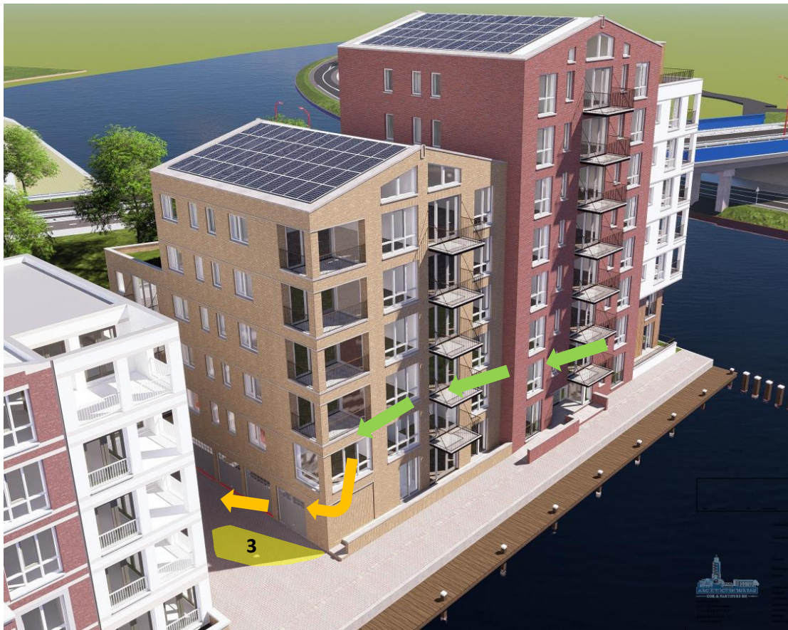
Figuur 8: Illustratie van de versnellingen van de lucht de steeg in tussen het appartementencomplex en de naast gelegen nieuwbouw die zal optreden als wind uit het westen komt. De lucht met een hogere snelheid oranje gekleurd.
