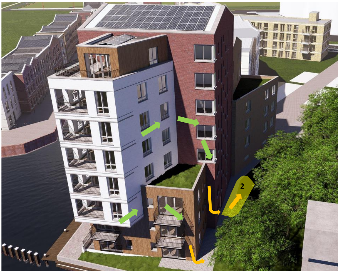
Figuur 7: Illustratie van de versnellingen van de lucht die zullen optreden bij de zuidwestelijke hoek van het gebouw als wind uit het zuidwesten komt. De lucht met een hogere snelheid oranje gekleurd.
