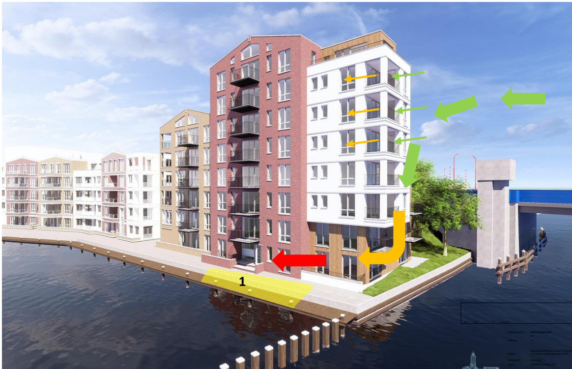
Figuur 6: Illustratie van de versnellingen van de lucht die zullen optreden bij de westelijke hoek van het gebouw als wind uit het zuidwesten komt. De lucht met een hogere snelheid rood gekleurd.
