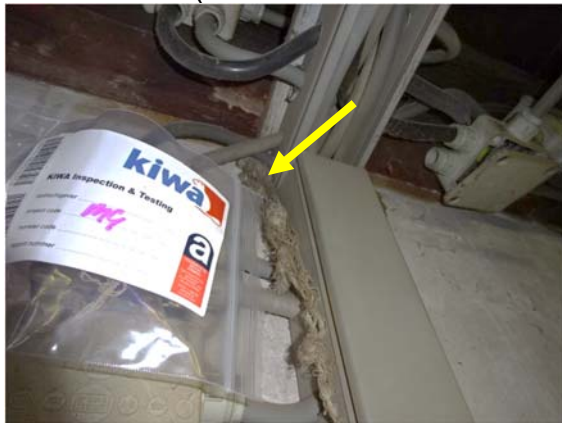
Foto 3: Koord / touw in muurdoorvoeren van loods 4 (niet asbesthoudend / zie M-4)
