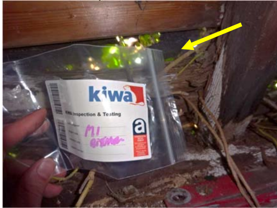
Foto 1: Bitumen tussen hout dakbeschot + dakpannen van loods 4 (niet asbesthoudend / zie M-1 + M-2)
