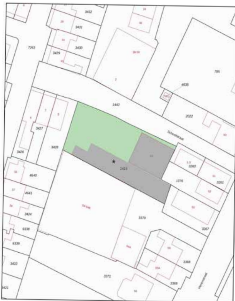
6 Kadastrale kaart waarop de bebouwing van het kavel zichtbaar is (grijs). Achter op het kavel het langwerpige gebouw met aanbouw. Daarvoor de vierkante loods die tegen de houten schuur is geplaatst.
