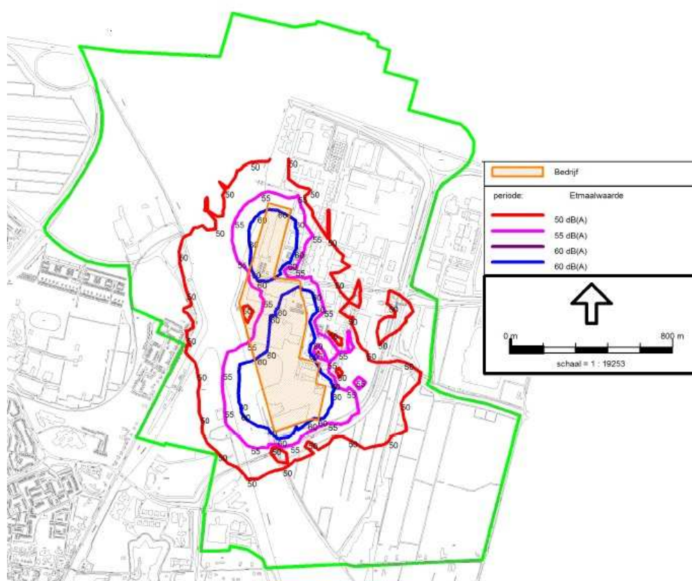
Figuur 4.2 Geluidscontouren Voorstel De Liesbosch ten opzichte van vigerende zone (groene lijn)
