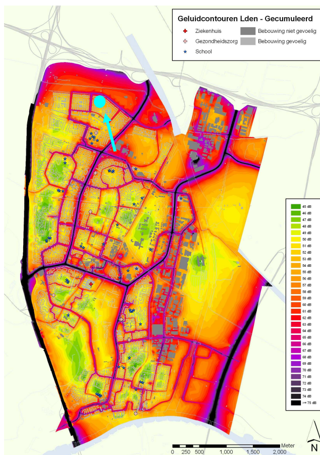
Figuur 1: Nieuwbouwlocatie, geprojecteerd op geluidbelastingkaart
