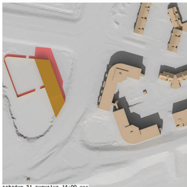
schaduw 21 augustus 14:00 uur
