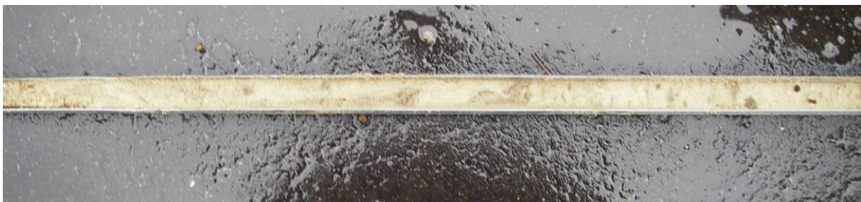
Figuur 16; Het schone gele zand met daarin brokken humeus zand zoals dat in alle boringen tussen de top laag en de onverstoorde C-horizont is aangetroffen.
