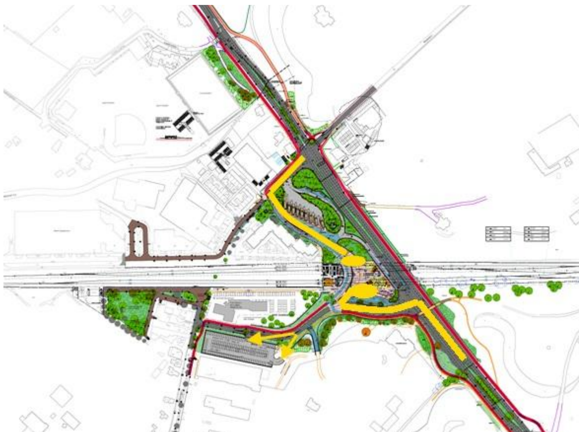
Afbeelding10: Aanrijdroutes en opstelplaatsen stationsgebied Driebergen-Zeist
