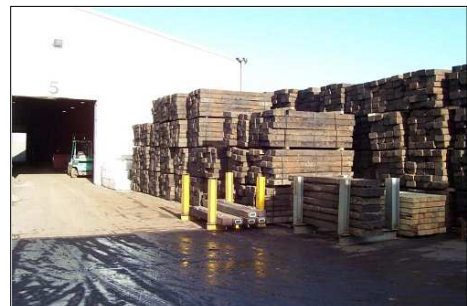
Figuur: Spoorbielzenopslag voor hergebruik.
