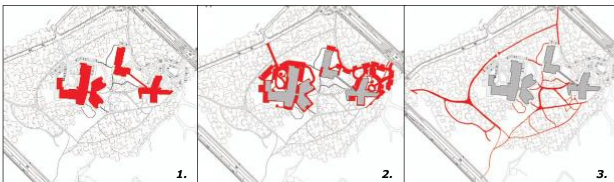
Overzicht huidige structuren: bebouwd oppervlak (1), verhard oppervlak (2) en halfverhard oppervlak (3) (bron: Herinrichting Warande, Bureau B+B stedenbouw en landschapsarchitectuur, 17 juni 2014)
