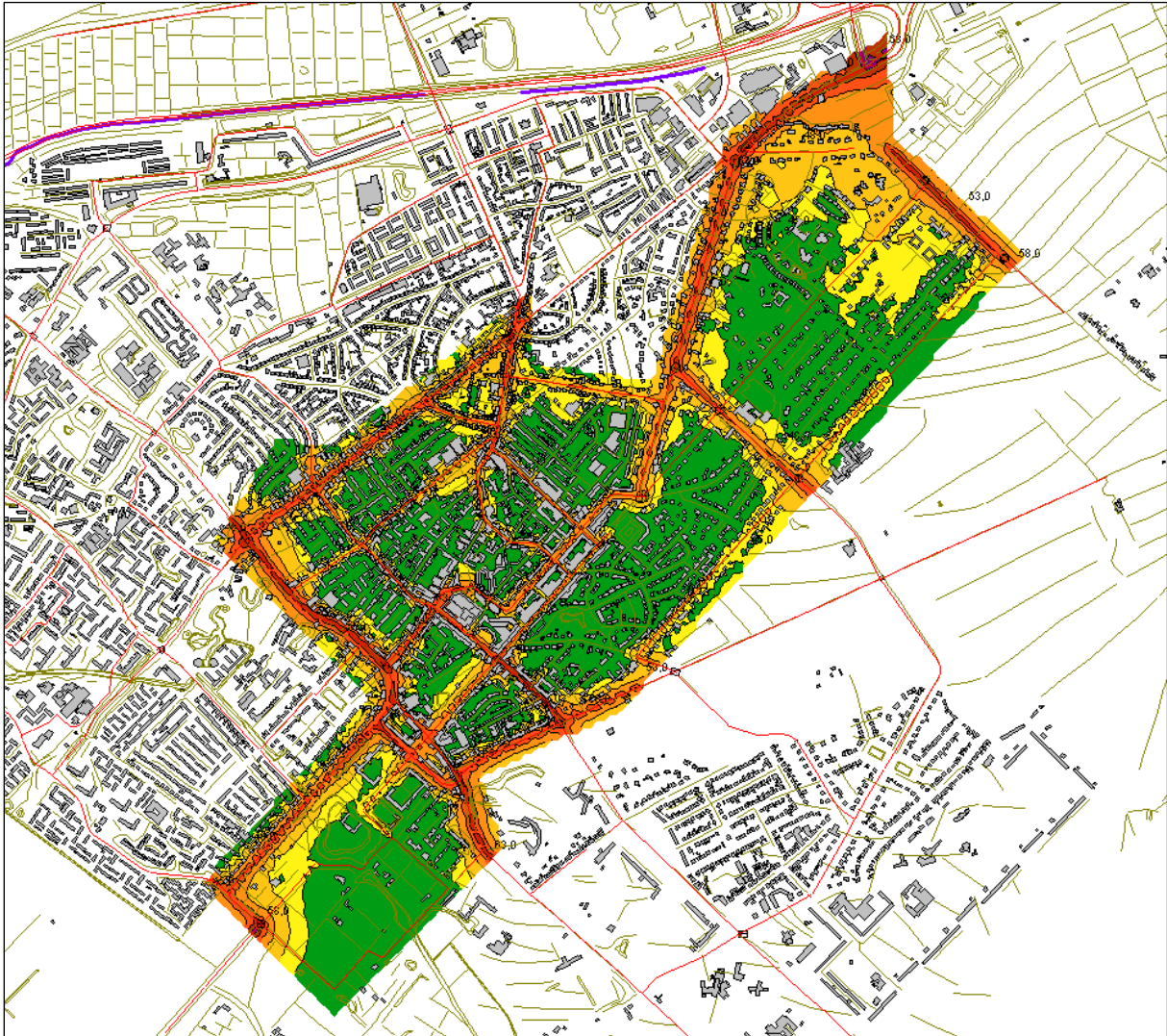
Figuur 3: geluidsbelasting ten gevolge van het wegverkeer in en rond het centrumgebied
