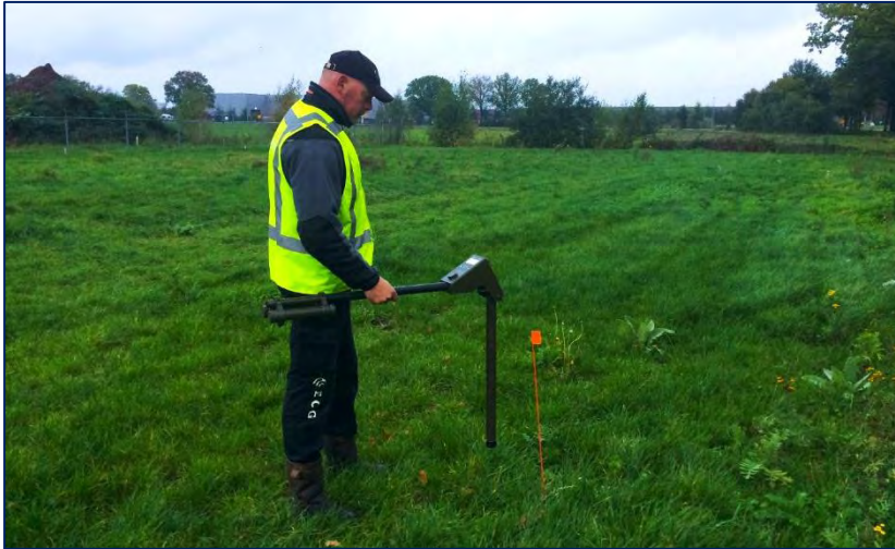
Figuur 3: detectie in uitvoering met behulp van een passief meetsysteem.
