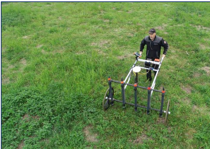
Figuur 2: Non-realtime detectie met een 5-kanaals meetstelsel
