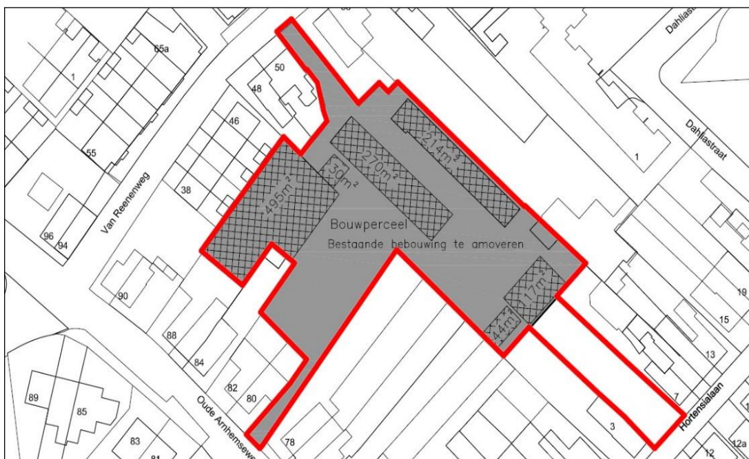
Figuur 9: Overzicht te slopen bebouwing (bron: RCBouwplan b.v., bewerkt mRO)
