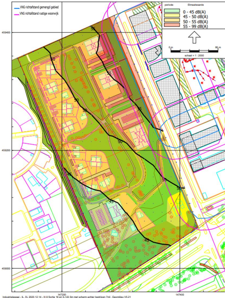
Figuur III.9 VNG richtafstanden / Geluidcontouren Suez ontv.h. 22,5 m / schermen 7m
