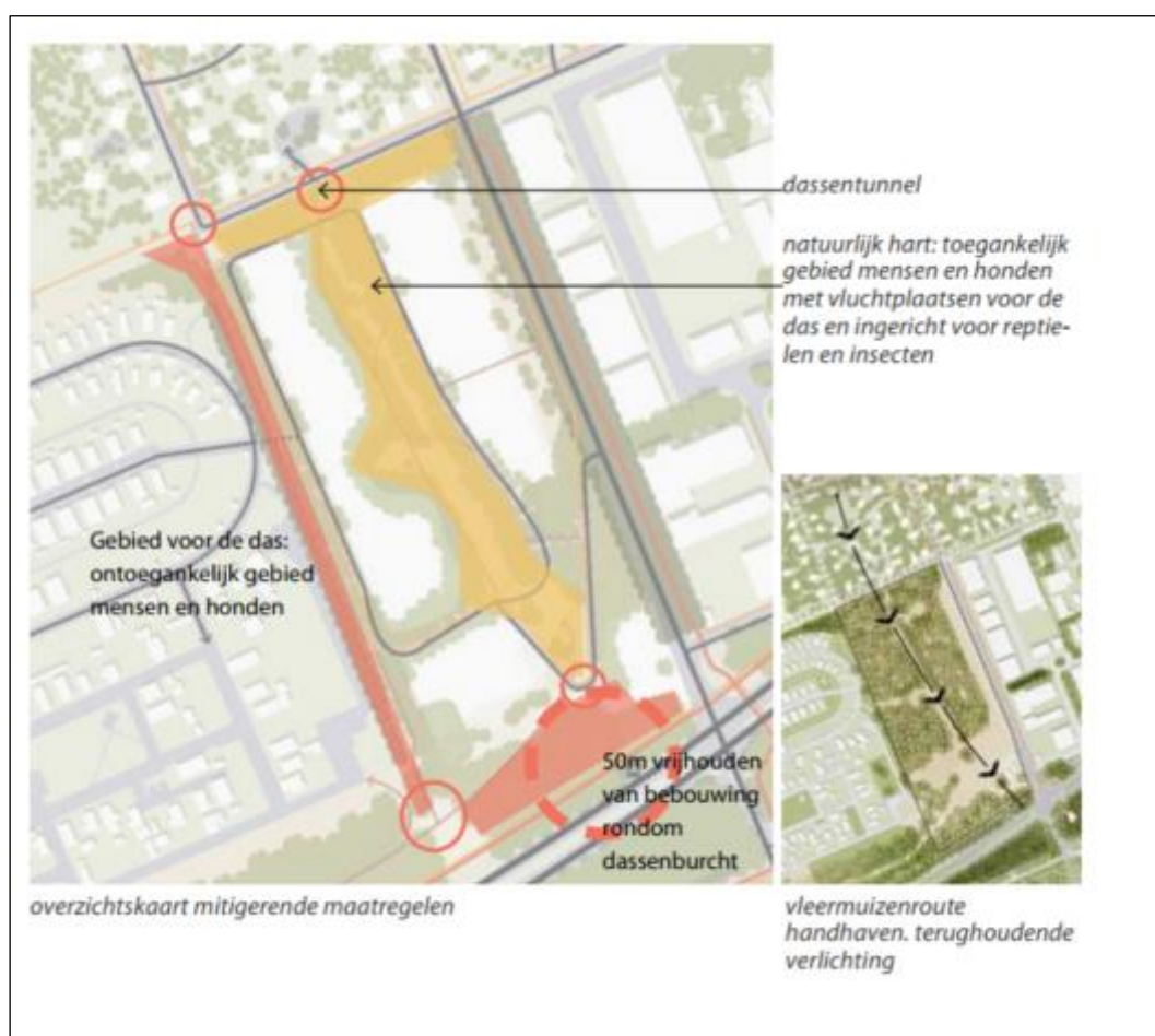
Figuur 7.1 Kaart met mitigerende maatregelen ten gunste van vleermuis, dassen, reptielen en kommavlinder die bij het ontwerp en de aanleg van de woonwijk worden geïmplementeerd. Bron: BGSV (2021).
