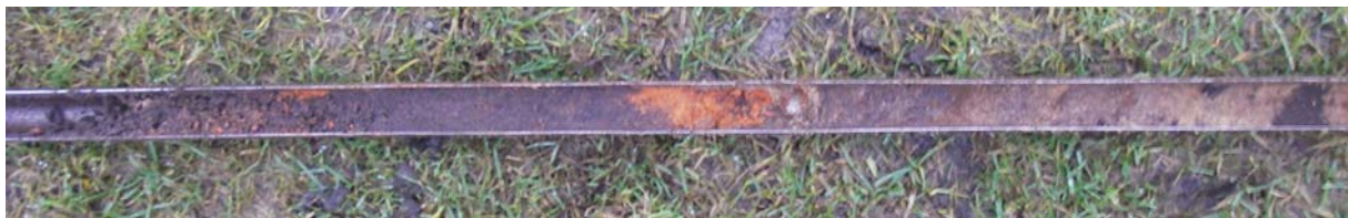
Figuur 4: Foto van boring 11 met het daarin aangetroffen baksteen.
