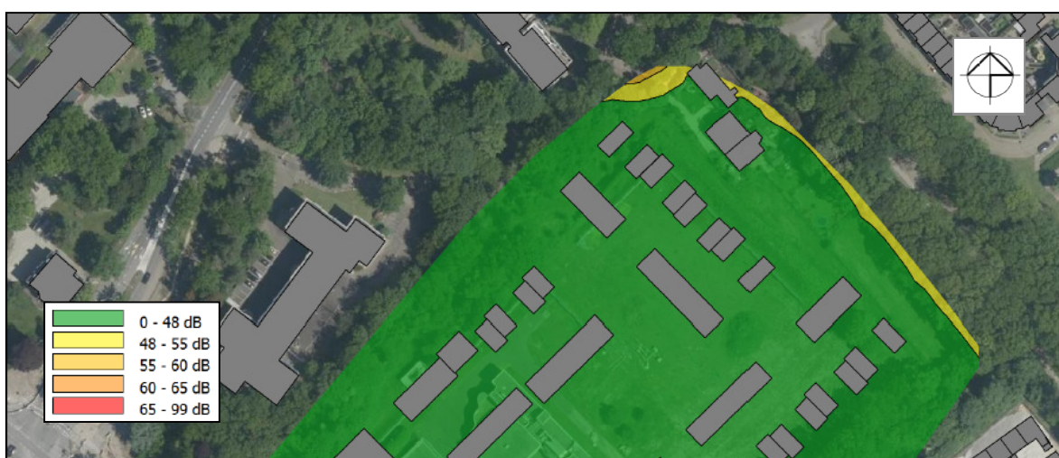
Figuur 4.4: Geluidscontouren 30km/uur-wegen plansituatie (waarden zonder correctie(s))
