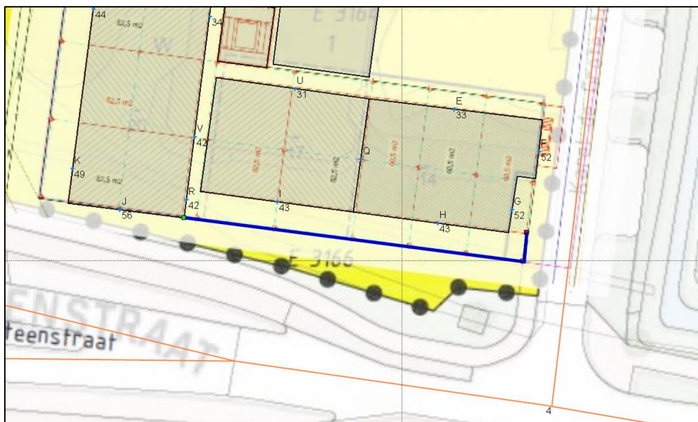
Figuur 11 Geluidsbelasting (dB, incl. aftrek 110g Wgh) op 1 e verdieping, afscherming hoogte 1,2 m (blauwe lijn) boven verdiepingvloer
