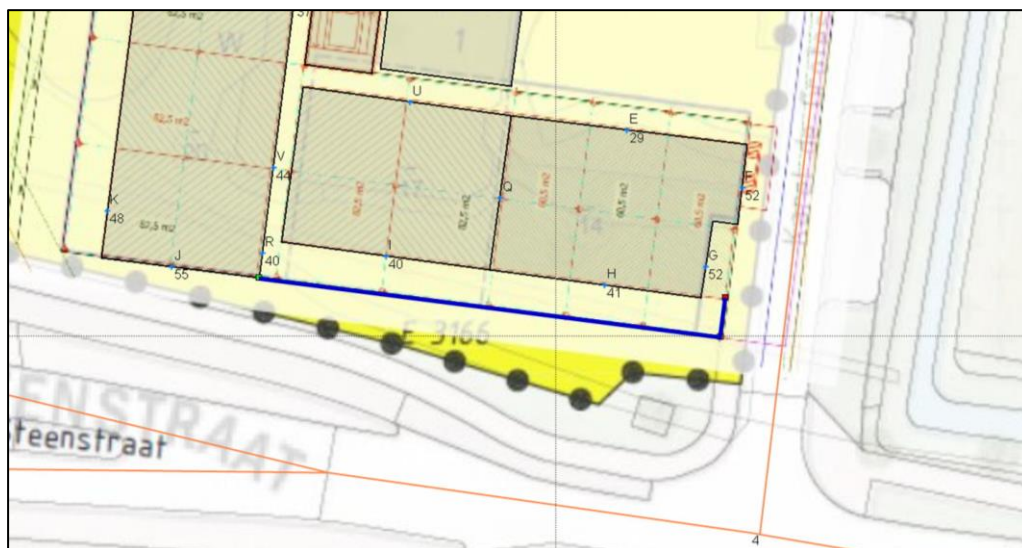
Figuur 14 Geluidsbelasting (dB, incl. aftrek 110g Wgh) op 4 e verdieping, afscherming hoogte 1,2 m (blauwe lijn) boven verdiepingvloer
