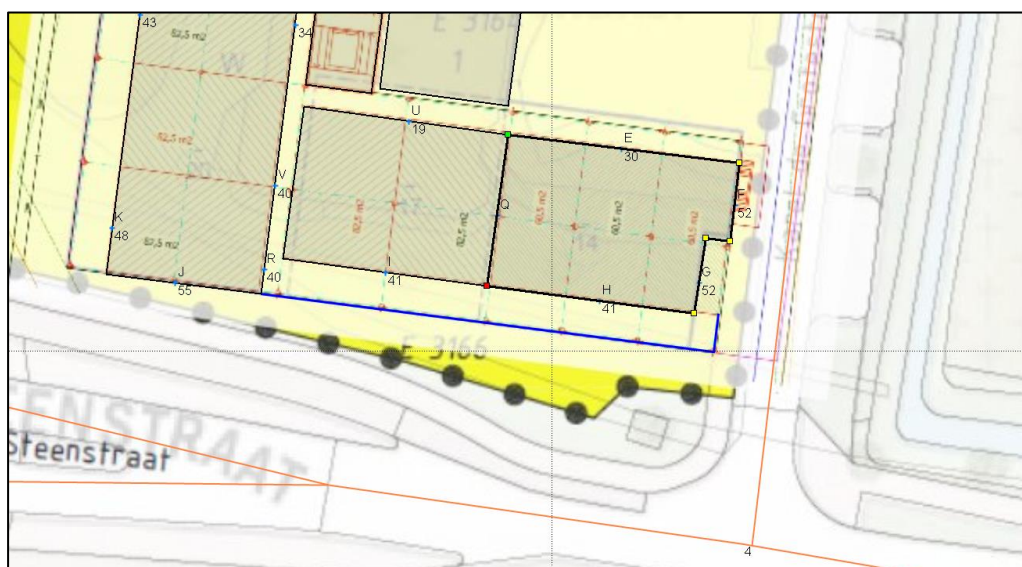
Figuur 13 Geluidsbelasting (dB, incl. aftrek 110g Wgh) op 3 e verdieping, afscherming hoogte 1,2 m (blauwe lijn) boven verdiepingvloer
