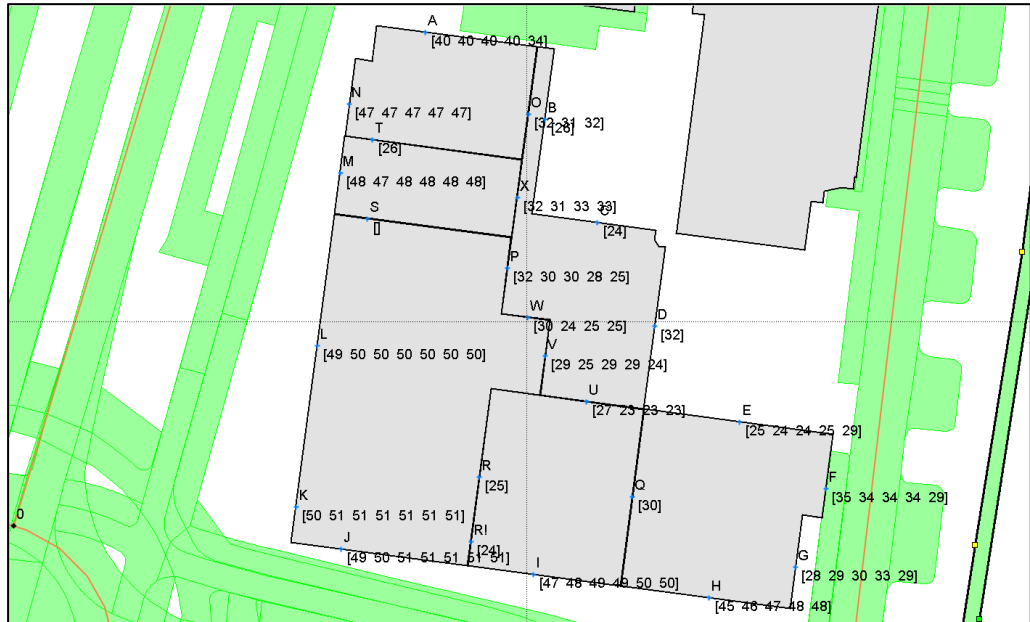
Figuur 5B Berekende geluidbelasting per wnp vanwege de Hordenweg inclusief aftrek conform artikel 110g Wgh
