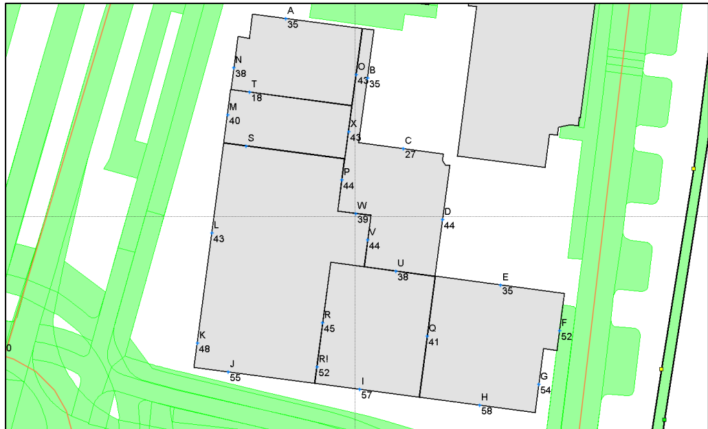
Figuur 7A Hoogst berekende geluidbelasting vanwege de Steenstraat inclusief aftrek conform artikel 110g Wgh
