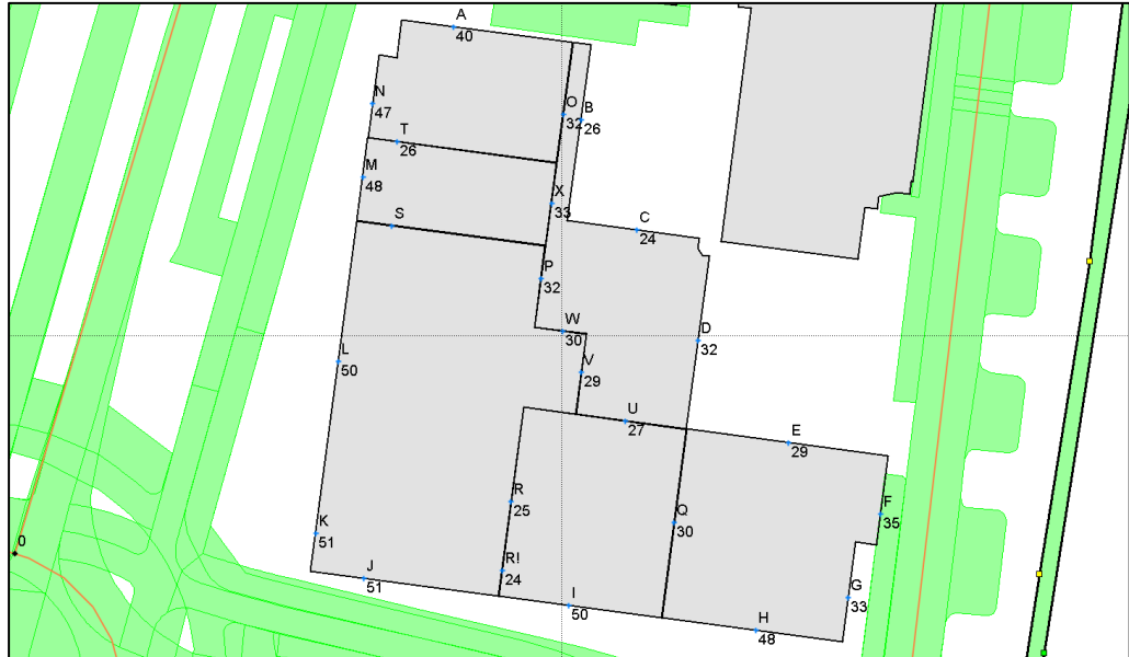
Figuur 5A Hoogst berekende geluidbelasting vanwege de Hordenweg inclusief aftrek conform artikel 110g Wgh
