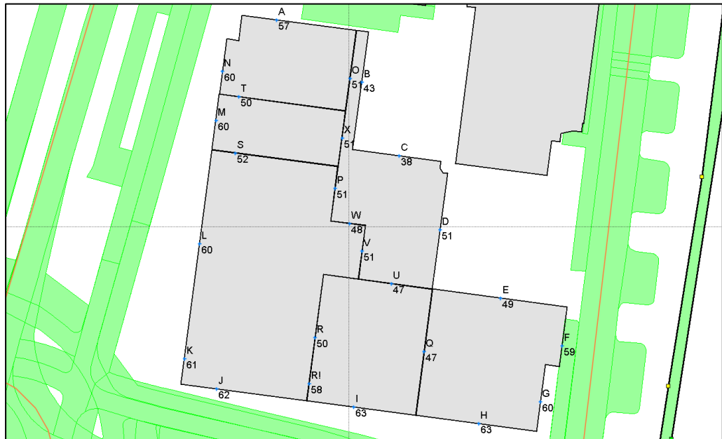
Figuur 10A Hoogst berekende geluidbelasting vanwege alle getoetste wegen exclusief aftrek conform artikel 110g Wgh
