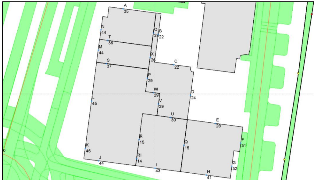
Figuur 6 Hoogst berekende geluidbelasting vanwege de Boterslootweg inclusief aftrek conform artikel 110g Wgh
