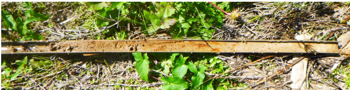
Figuur 19: Foto van het pakket sterk zandige klei met oxidatievlekken (links) met daaronder het pakket matig grof zand (rechts) zoals dat in de meeste boringen is aangetroffen.
