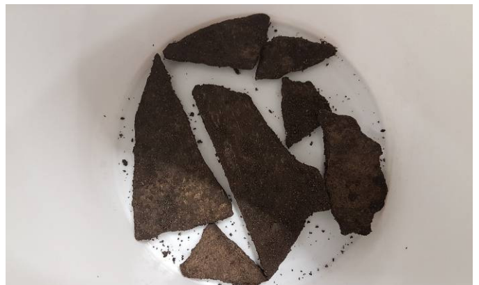
Foto 16: asbestverdacht materiaal SL43
