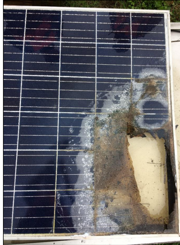
Figuur 8: Zonnepaneel is alleen in vuurzone opgebrand
