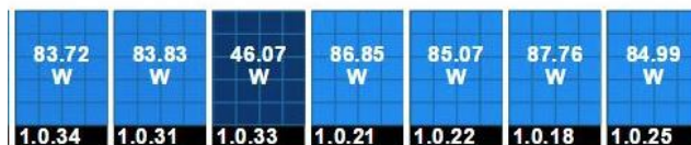
Figuur 4: Visualisatie vanuit het Solar Edge monitoringsportal, één paneel met afwijkende waarde
