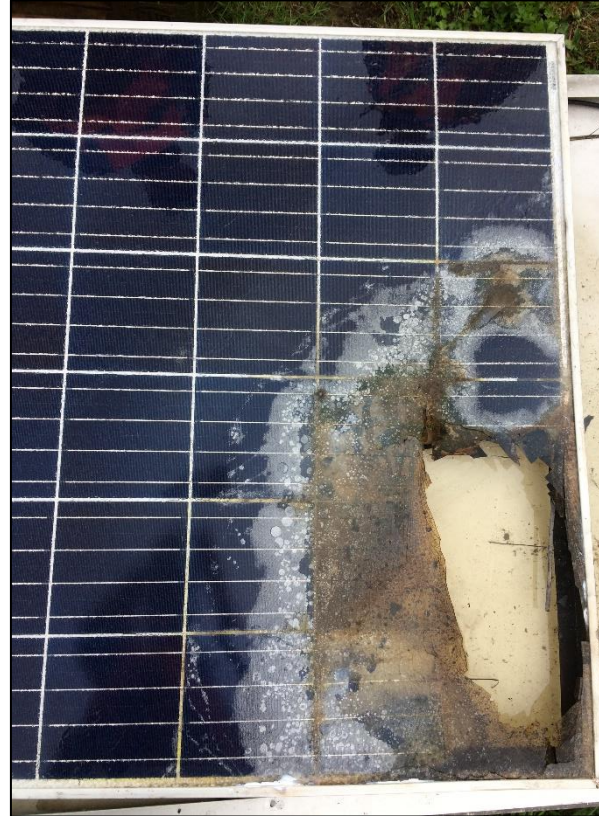
Figuur 8: Zonnepaneel is alleen in vuurzone opgebrand
