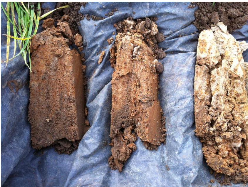
Boring 5: Mogelijk Bs, maar waarschijnlijker is dat het, het bovenste deel van de C-horizont betreft, waarin veel ijzeroxide vlekken voorkomen.
