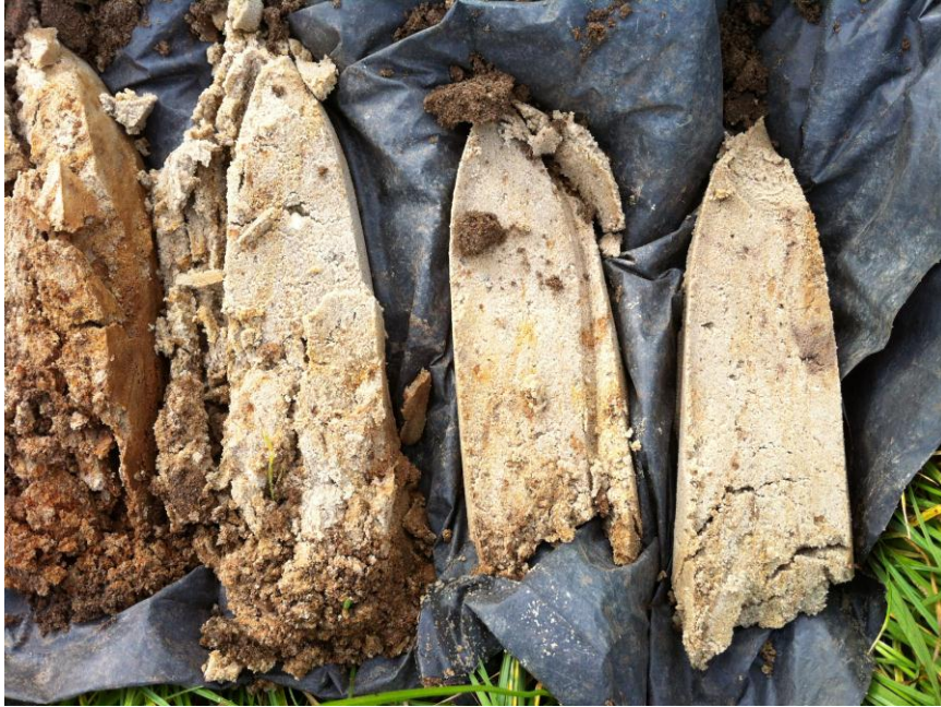
Boring 5: Gereduceerde C-horizont van de beekgrond, met lokaal nog een enkele roestvlek.
