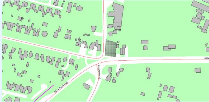
figuur 2: grafische weergave akoestisch rekenmodel inclusief rekenraster (midden op de afbeelding)
