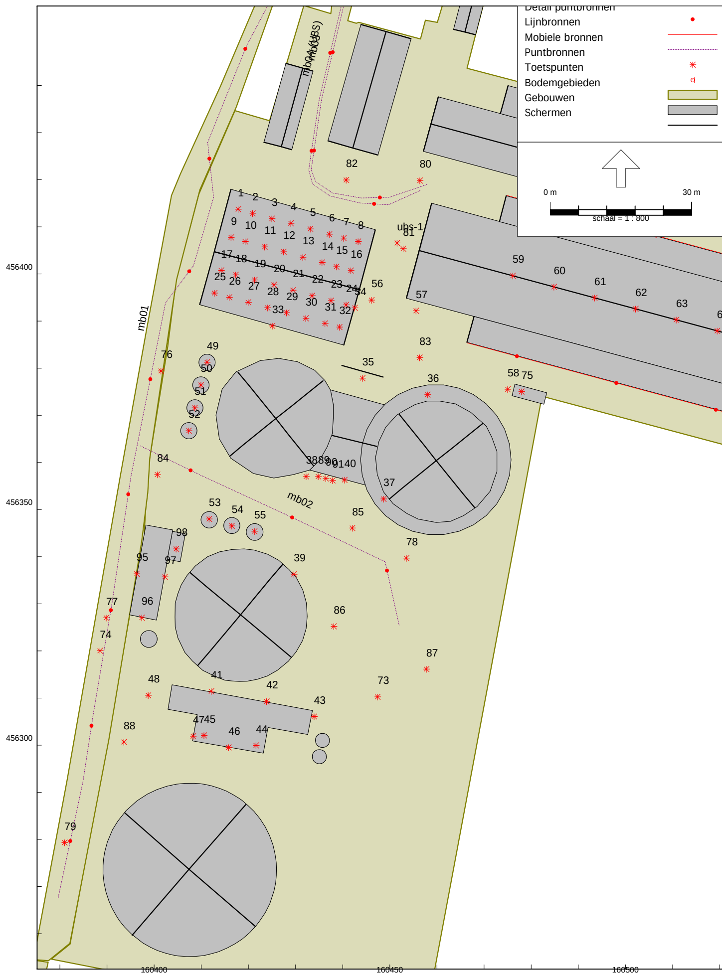
Overzicht van het akoestische rekenomodel met de ligging van de equivalente geluidbronnen (LAr,LT) - RBS/UBS
