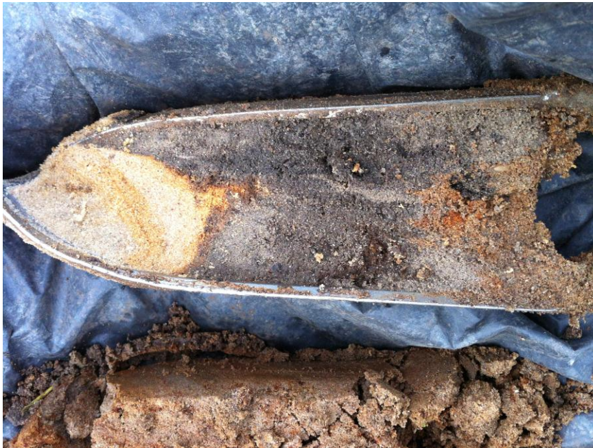
Boring 1: scherpe overgang op 50 cm –Mv. Licht geel zand is waarschijnlijk een boomwortel.
