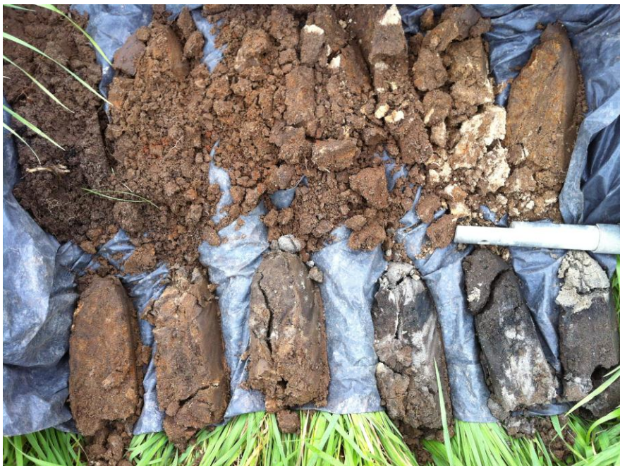
Boring 3: Overzicht boorkernen met rechtsonder een humeus niveau met veel Schelpfragmenten. Dit niveau is hier als een beekbodem geïnterpreteerd.
