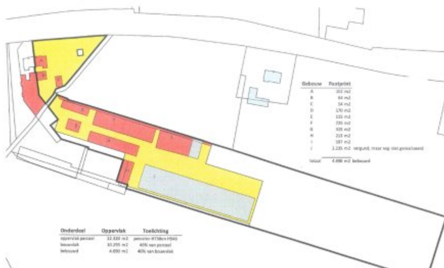
Afbeelding 5: Huidige bouwpositie. Gebouwen F, G, en I worden gesloopt. Bron: opdrachtgever
