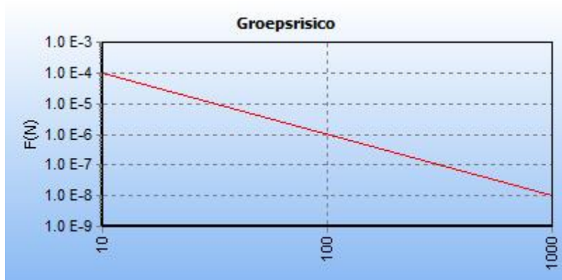
5.4 Figuur 5.4 FN curve voor 2629_leiding-W-520-06-deel-1 van N.V. Nederlandse Gasunie voor de kilometer tussen stationing 2110.00 en stationing 3110.00
