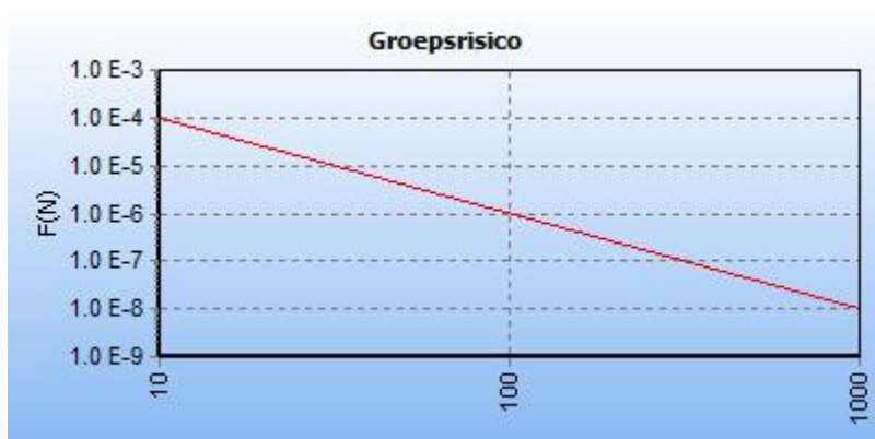
5.2 Figuur 5.2 FN curve voor 2629_leiding-W-520-02-deel-1 van N.V. Nederlandse Gasunie voor de kilometer tussen stationing 0.00 en stationing 680.00
