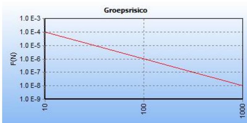
5.2 Figuur 5.2 FN curve voor 2629_leiding-W-520-02-deel-1 van N.V. Nederlandse Gasunie voor de kilometer tussen stationing 0.00 en stationing 680.00
