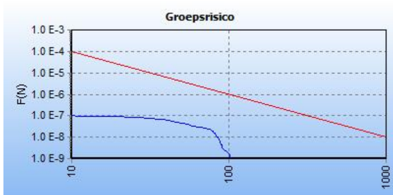
5.4 Figuur 5.4 FN curve voor 2629_leiding-W-520-06-deel-1 van N.V. Nederlandse Gasunie voor de kilometer tussen stationing 2110.00 en stationing 3110.00
