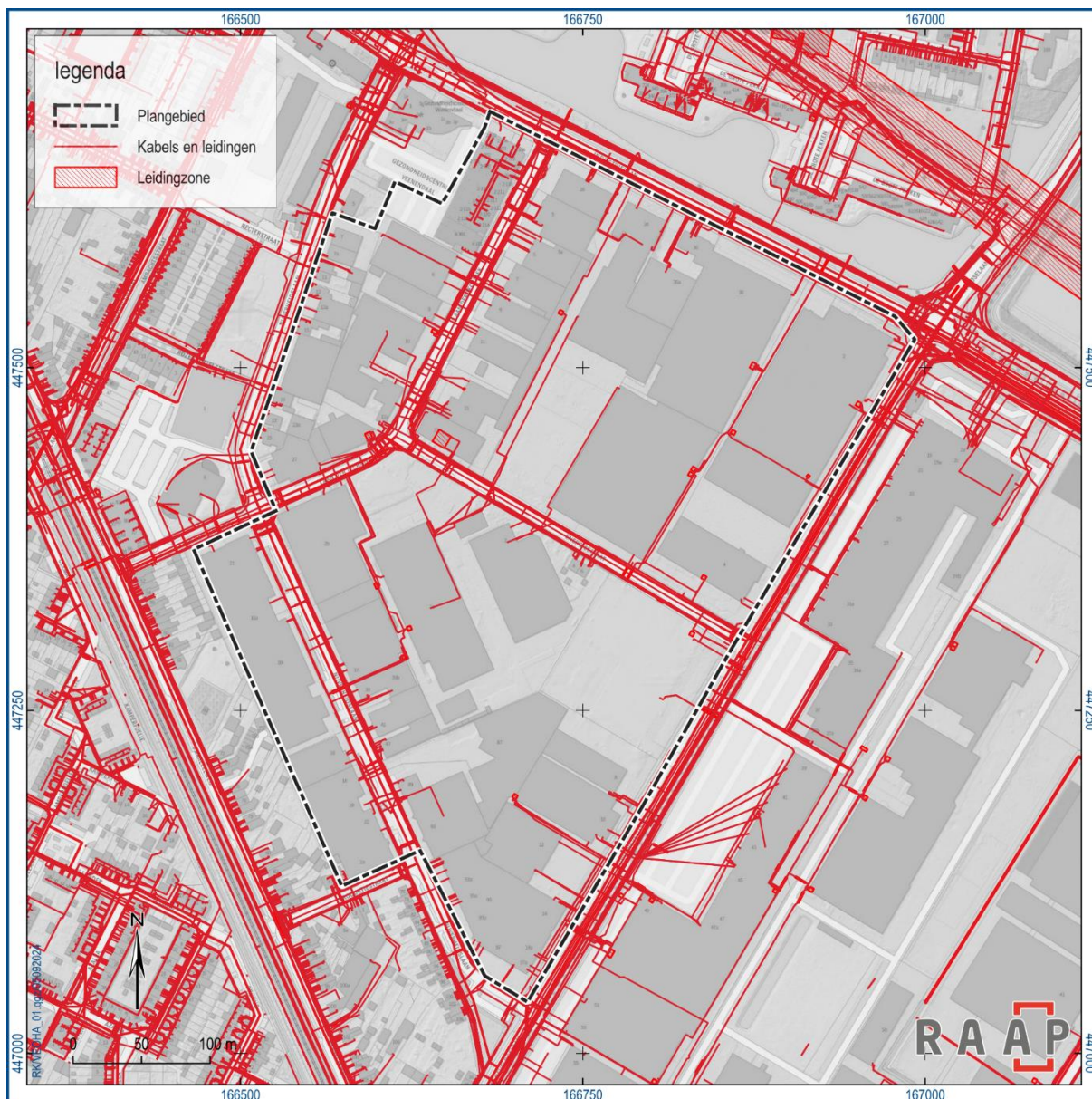
Figuur 20. Kabels en leidingen (KLIC).
