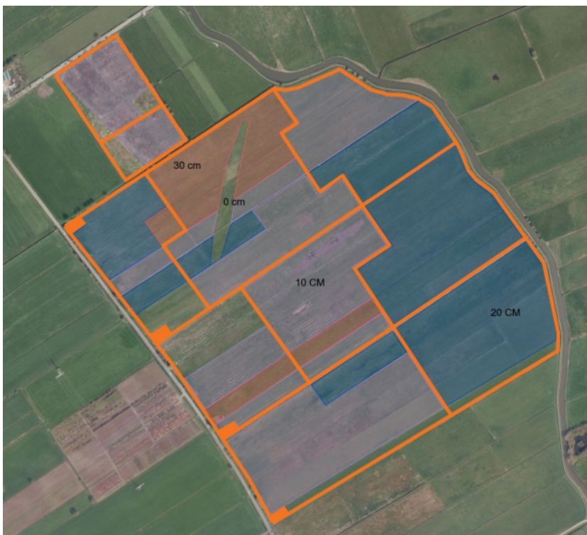
Figuur 5 - Grondverzet Achterbergse Hooilanden op basis van het inrichtingsplan
