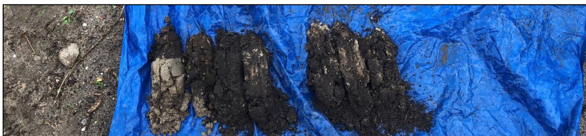
Boring 2: 0-70 cm -Mv. Eerste poging van de drie. Gestaakt op rood/kalkmortel puin
