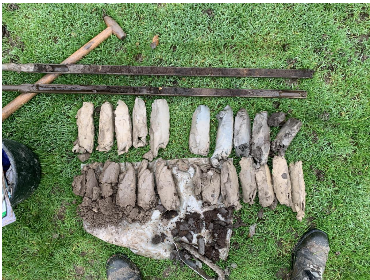
Boring 31; Van linksonder naar rechtsboven, boorkernen uitgelegd tot 2,0 m -Mv. Daaronder twee gutsen tot respectievelijk 3,0 en 4,0 m -Mv.
