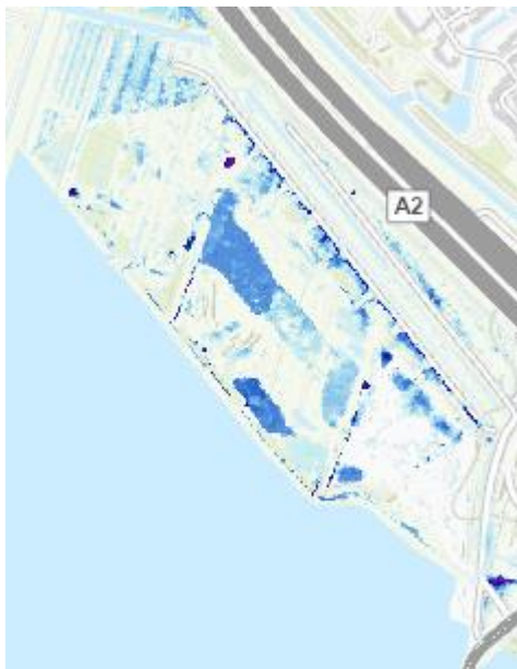
Figuur 8 Rekenresultaten water-over-straat berekening bij 80 mm blokbui.
