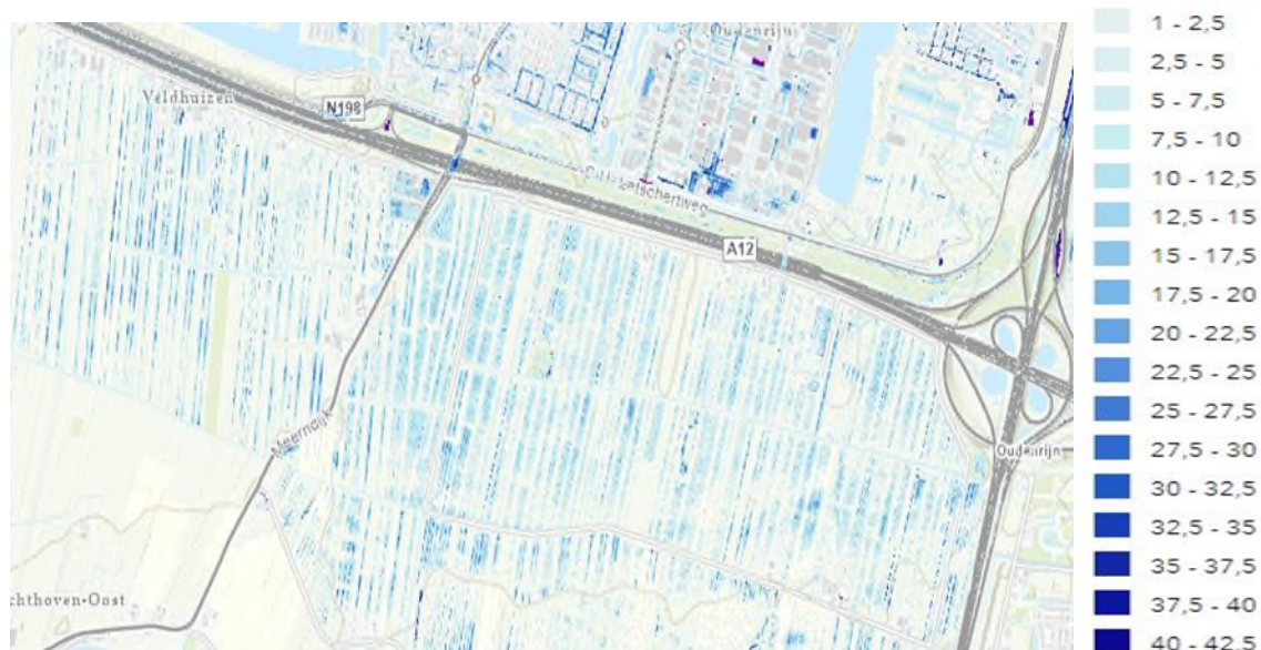
Figuur 9 Rekenresultaten water-over-straat berekening bij 80 mm blokbui.
