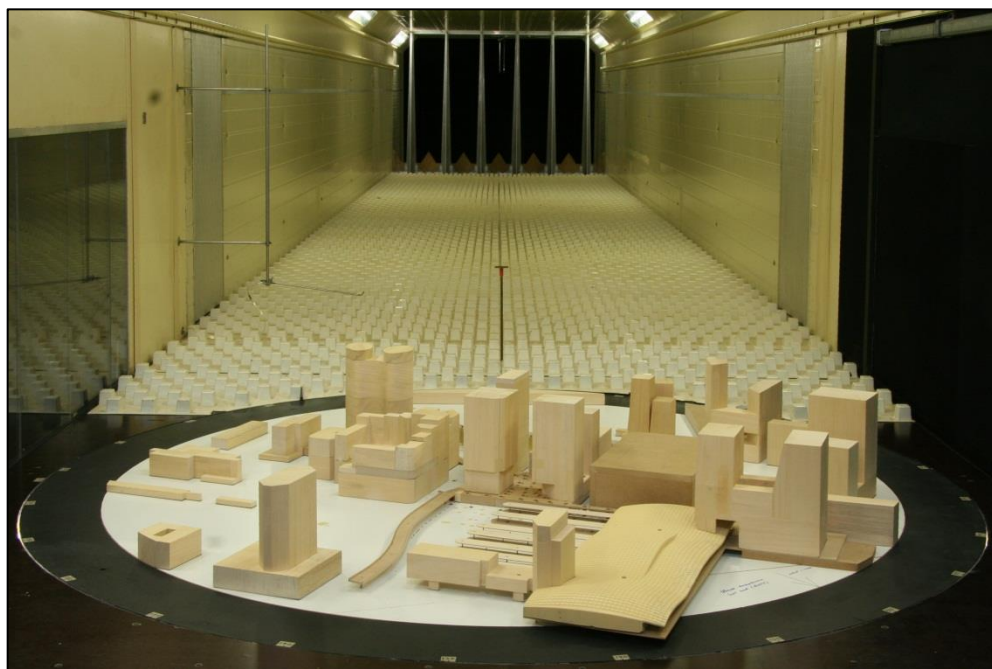
Figuur 2 Maquette van het Knoopkazerne complex te Utrecht, in de windtunnel van TNO te Apeldoorn (schaal 1:300).
