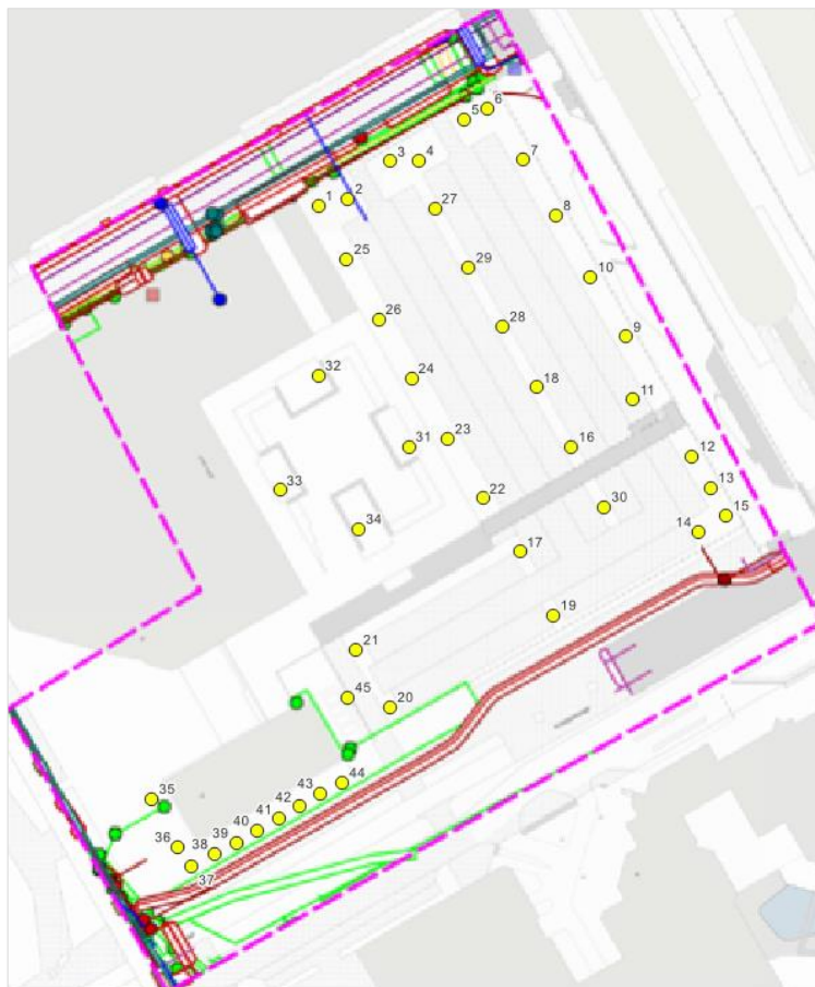
Figuur 4.10 Kabels en leidingen onder boompunten.
