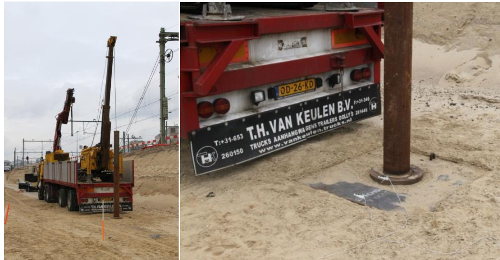
Figuur 5-7 Opstelling valgewicht (links) en voetplaat en geleidingsbuis (rechts)
