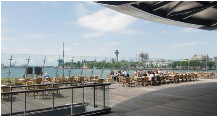
Afbeelding 8: Schermen om de aanstromende wind op te vangen bij het Wold Port Centre te Rotterdam
